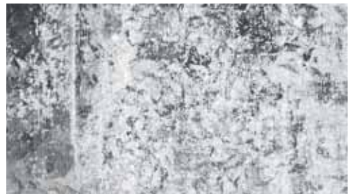
Valkoruoste on poistettava ennen maalausta esimerkiksi biomalla. Rasva- ja vesiliukoisten epäpuhtauksien poistoon käy Panssari pesuaine.
