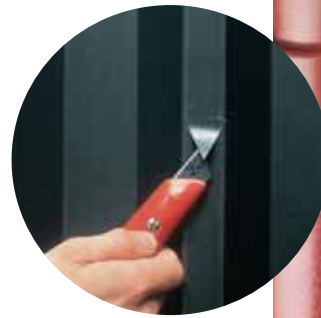
X-viiltokokeella tarkistetaan pinnoitteen tartunta alustaan.
